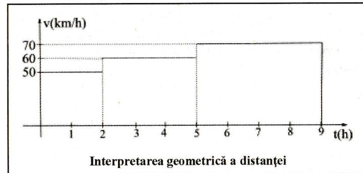
permanent în timp. Dacă legea vitezei este  $v(t)$ , din  $v(t) = dx/dt$  (ceea ce înseamnă că viteza este egală cu derivata întâi a coordonatei se obține deplasarea elementară  $dx = v(t)dt$ ).
