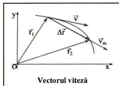
Un mobil se mișcă în raport cu un punct care poate fi considerat origine a mișcării, în care se află la un moment de timp dat căruia îi spunem moment inițial. Poziția mobilului este descrisă în raport cu originea unui sistem de coordonate prin intermediul vectorului de poziție,  $\vec{r}$ . Rapiditatea cu care mobilul se mișcă este caracterizată de o mărime fizică vectorială cunoscută ca viteza; aceasta poate fi medie și momentană:
